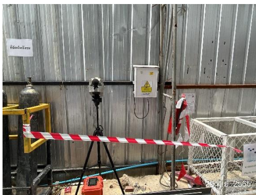
ภาพที่ 3.5.5-1 การเก็บตัวอย่างเพื่อการตรวจวัดความสั่นสะเทือน/การพังทลายของดิน
